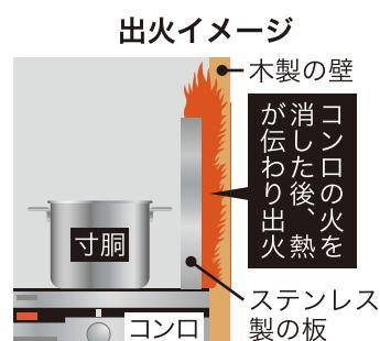
スープを作る寸胴鍋を加熱するコンロから、近くの壁の内部に熱が伝わってこもり、突然発火したそうです。
